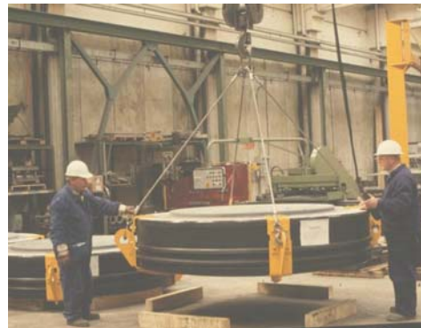
Şekil 10-Marquam Köprüsünde uygulanan çelik histeretik dağıtıcılarla birlikte kayıcı mesnet elemanları, Oregon, ABD (solda) ve Chirag I deniz a°ırı platformunda kullanılanlar (sağda).
