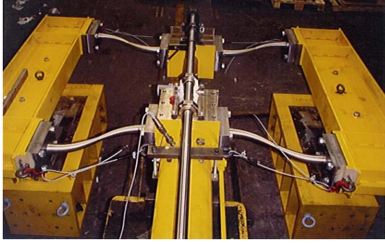
Şekil 7- Çift toplu iğne görünümlü sönümleyici test edilirken ve histeretik döngüleri.
