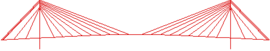
Şekil 3. Jindo köprüsüne ait iki boyutlu sonlu eleman modeli.
