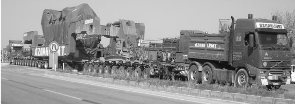
Şekil 2. İstisnai ağır yük ve taşıma sistemi.
