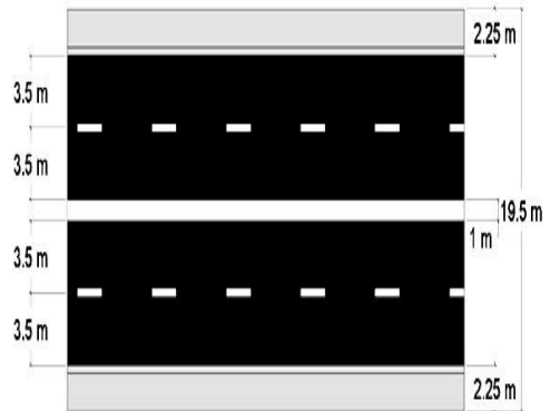
Şekil 4. Kullanılan ağır vasıta tipi ve tabliye üstüne kurulacak olan yol planı
